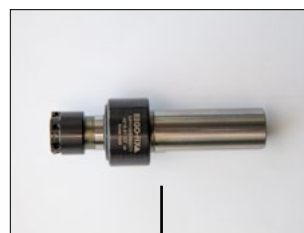
フランジ側面に二つのねじがあるタイプ
